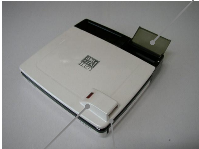
바코드레이저 스캐너 (바코드를 근접시키면 레이저빔 발생)
