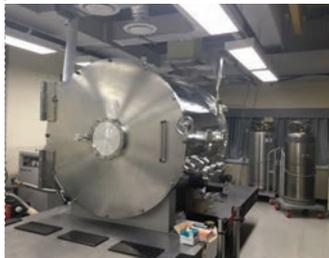
다목적 진공챔버를 이용한 우주망원경 성능시험, 환경시험
