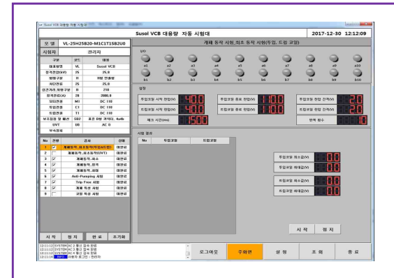
차단기 자동검사 S/W
