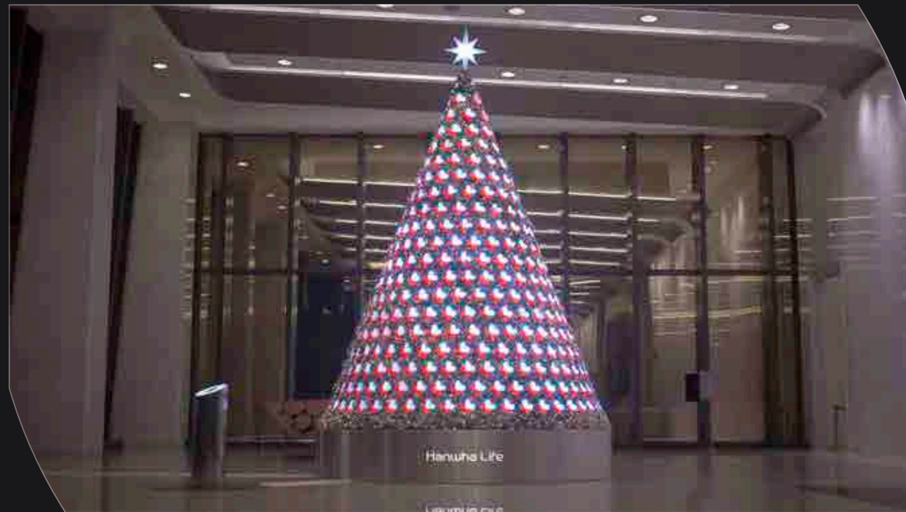
2017 / 한화생명 - 63빌딩 Life Plus 겨울시즌 미디어트리 500여개 조명모듈, 모듈설계, 조명제어 시스템, 손바닥 인식 인터랙션
