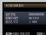
총 릴리즈 횟수를 카메라가 카운트하여 알기 쉽게 전달합니다 (1,000회 단위). 카메라 유지보수 타이밍을 쉽게 파악할 수 있어 시스템 트러블을 예방하는데 효과적입니다. 또한 카메라의 시리얼 번호와 펌웨어 버전, 이전에 발생했던 에러 등의 이력을 확인할 수 있습니다.
