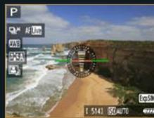
수평 방향뿐만 아니라 전후 방향의 기울기도 감지하여 1도 단위로 표시합니다. 라이브 뷰 촬영 시, 동영상 촬영 전에는 영상과 수평계를 중첩시켜 표시할 수 있으므로 피사체로부터 눈을 뗄 필요가 없이 구도와 기울기를 동시에 확인할 수 있습니다. 또한 파인더에서도 AF 포인트로 기울기가 표시됩니다.
