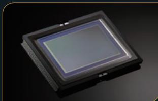
이미지 화소의 크기, 화소수, S/N 비와 같은 고화질을 위한 중요 요소들과 고속 판독 밸런스를 최적화하여 35mm 풀 프레임 사이즈의 CMOS 센서를 새로이 개발하였습니다. 유효 화면 사이즈 약 36.0x24.0mm, 유효 화소수 약 1,810만 화소의 넓은 화면과 높은 해상도로 표현되는 선명한 디테일이 이미지에 강한 인상을 불러 넣습니다. 6.95x6.95 $\mu$ m의 여유로운 화소 크기와 더욱 넓게 확보된 포토다이오드의 수광 면적, 마이크로렌즈의 캡리스화로 우수한 집광 효율과 저 노이즈를 달성함으로써 말로는 표현하기 힘든 고화질을 만들어 냅니다.
