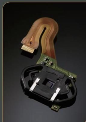
10만 화소의 RGB 측광 센서와 AE 전용의 이미지 프로세서가 결합된 새로운 AE 시스템 : EOS iSA (Intelligent Subject Analysis) System을 탑재함으로써 피사체의 밝기 외에도 얼굴과 색상까지 인식하여, 이를 근거로 보다 정확한 피사체 검출 데이터를 산출해 냅니다. 따라서 휘도 차이나 피사체의 색상 영향을 억제한 안정된 노출 제어를 실현할 수 있으며, 또한 AF 시스템과도 연계하여 피사체의 포착이나 움직임은 피사체의 추적이 정확해지는 등 AF의 기능도 크게 향상시킬 수 있게 되었습니다.
