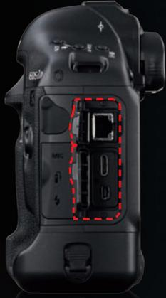
본체에 유선 LAN 기능을 탑재 (Ethernet 1000 BASE-T 대응)하여 무선 파일 트랜스미터를 연결하지 않아도 스튜디오 등의 LAN 환경에 접속할 수 있습니다. 케이블 길이의 제약이 없으므로 원거리에서 카메라를 조작하여 이미지를 전송하고 싶을 때에도 효과적입니다. 촬영 이미지의 전송 (FTP 서버)이나 네트워크 상에서의 원격 라이브 뷰 촬영 (EOS Utility), Web 브라우저를 사용한 원격 촬영/이미지 다운로드 (WFT 서버) 등의 작업이 가능합니다. 또한 DLNA 호환 기기에서 이미지를 재생할 수 있는 미디어 서버 기능도 갖추고 있습니다.
