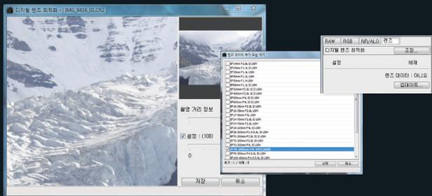
렌즈에서 들어온 빛이 카메라 내의 필터 등을 통과할 때 발생하는 광학적 영향으로 인해 색 번짐이나 초점의 불일치 현상이 발생합니다. Digital Photo Professional\*의 신기능, 디지털 렌즈 옵티마이저는 빛의 전달 계수를 함수화·필터화하여 수광 이미지에 적용함으로써 이 광학적인 영향을 보정합니다. 그에 따라 영상의 중심부와 주변부에서 해상감과 묘사력이 향상되는 등 구석구석까지 고화질로 완성된 이미지를 얻을 수 있습니다. 캐논이 CMOS 센서/EF 렌즈/소프트웨어를 일관적으로 설계, 제조함으로써 이와 같은 고정밀 보정과 뛰어난 효과가 가능합니다.
