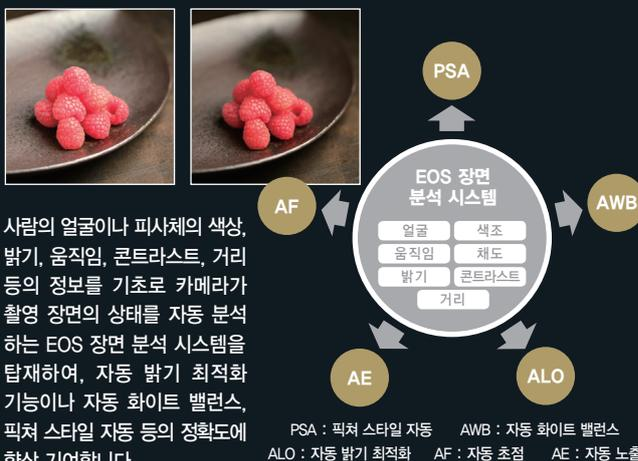
사람의 얼굴이나 피사체의 색상, 밝기, 움직임, 콘트라스트, 거리 등의 정보를 기초로 카메라가 촬영 장면의 상태를 자동 분석하는 EOS 장면 분석 시스템을 탑재하여, 자동 밝기 최적화 기능이나 자동 화이트 밸런스, 픽처 스타일 자동 등의 정확도에 향상 기여합니다
