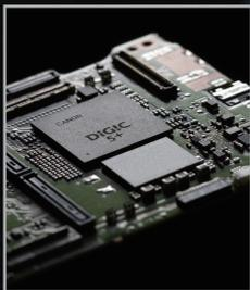
EOS 5D Mark III의 풀 프레임 센서가 포착하는 약 2,230만 화소의 대용량 데이터를 고속으로 처리하여 최고 약 6프레임/초의 고속 연속 촬영을 가능하게 한 신개발 DIGIC 5+ 이미지 프로세서는 DIGIC 4의 약 17배에 달하는 처리 능력을 지니고 있습니다. 뛰어난 노이즈 처리 알고리즘을 내장하여 상용 ISO 감도를 확장시키고, 다중 노출 촬영이나 HDR 모드, 렌즈 색수차 보정, 동영상의 신 압축 방식 지원까지, 최신의 다양한 기능들을 처리합니다.
