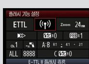
플래시 기능 설정값이 호환되는 EX 시리즈 스피드 라이트에서는 카메라의 메뉴 화면에서 스피드 라이트의 각종 기능들을 설정할 수 있습니다. 특히 EOS 5D Mark III는 새로이 개발된 스피드라이트 600EX-RT와 트랜스미터 ST-E3-RT에 대응한 전파 무선 제어 기능을 사용할 수 있습니다. 또한 플래시 기능 설정 상태를 직관적으로 쉽게 파악할 수 있도록 기능 설정 화면을 디자인하여 사용이 더욱 간편해졌습니다.
