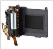
바디의 소형화에 맞춘 풀 프레임용 셔터 유닛을 새롭게 개발하여 탑재하였습니다. 약 10만회\*의 릴리즈를 견딜 수 있는 높은 내구성을 자랑하며, 선막 구동 레버와 후막 구동 레버를 다른 캠으로 차지하도록 설계하여 셔터 유닛의 가로폭도 단축하였습니다.
