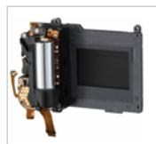
바디의 소형화에 맞춘 풀 프레임용의 셔터 유닛을 새롭게 개발하여 탑재하였습니다. 약 10만회<sup>\*</sup>의 릴리즈를 견딜 수 있는 높은 내구성을 자랑하며, 선막 구동 레버와 후막 구동 레버를 다른 캠으로 차지하도록 설계하여 셔터 유닛의 가로폭도 단축하였습니다.
