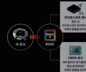
카메라 흔들림을 감지하는 알고리즘이 기존 EOS DSLR 카메라의 알고리즘에서 더욱 발전하였습니다. 이 IS 시스템은 렌즈의 자이로스코프 센서와 카메라의 CMOS 센서 모두에서 카메라 흔들림 데이터를 확보하여 기존 자이로스코프 센서만으로는 감지가 쉽지 않았던 저주파 (느린)의 흐림 현상을 더욱 정밀하게 감지하고 보정합니다. 5스톱\*2 상당의 더 빠른 셔터 속도로 카메라 흔들림에 더욱 효과적으로 대응할 수 있습니다.
