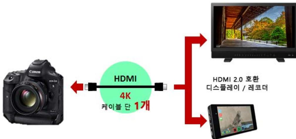
그림 11 HDMI 커넥터와 외부 기기 간 1개의 케이블 인터페이스만으로 모든 4K 형식 전송 가능
