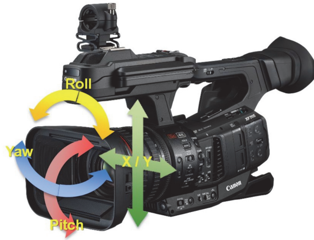
그림 12 XF705에 탑재된 손떨림 보정 기능의 독립 축 5가지
