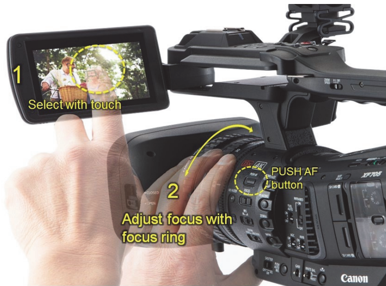
그림 9 정전 용량식 터치 스크린인 LCD 모니터는 확대를 포함하여 초점 프레임 이동을 지원합니다
