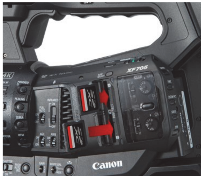
그림 23 XF705에서 사용 가능한 두 개의 SD 메모리 카드 - 편리하게 배치되어 사용이 쉽습니다
