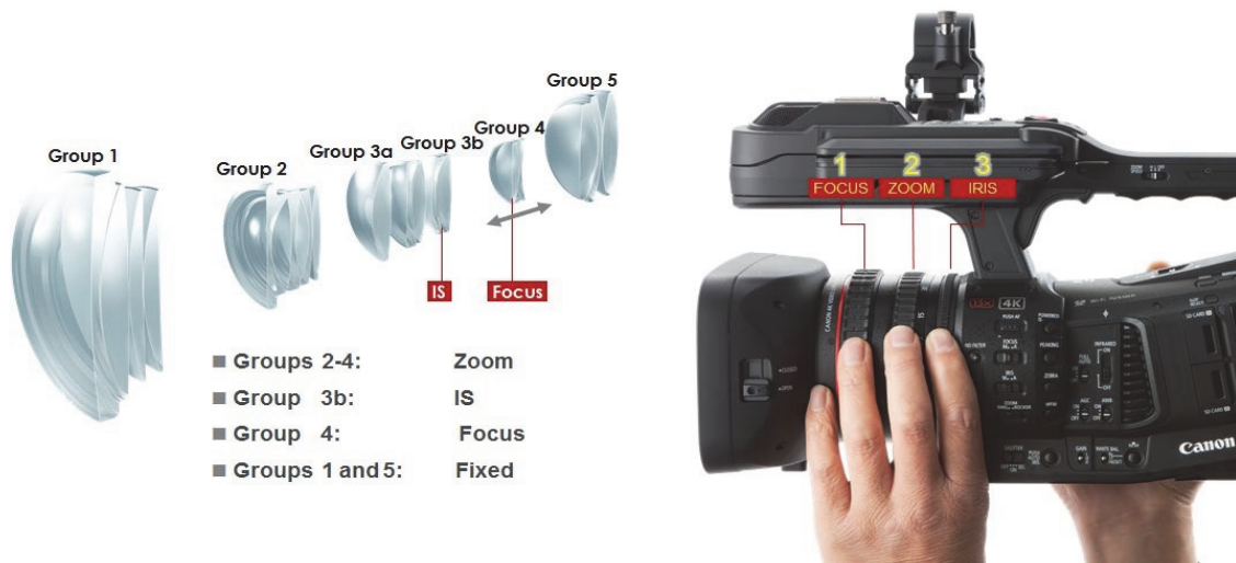
그림 3 14군을 구성하는 18매의 렌즈와 각각 줌, 포커스, 조리개 제어가 가능한 별도의 조작 링
