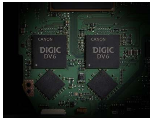
그림 13 레코딩 시 두 개의 DIGIC DV6 프로세서가 인코딩 전 모든 영상 처리를 실행
