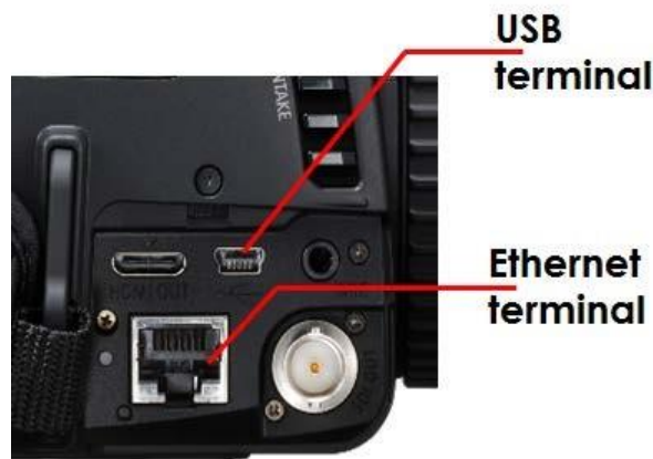
그림 22 FTP로 최대 100개 클립까지 파일 전송이 가능한 이더넷 커넥터 (1000 BASE-T 대응). XF405는 USB 커넥터를 통해 GP-ES GPS 수신기로부터 수신한 정보를 기록합니다
