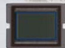
높은 해상도와 폭넓은 다이내믹 레인지를 가진 약 1,010만 유닛 픽셀의 대형 CMOS 센서 (28.1mm x 18.7mm)를 탑재하여 풍부한 계조 및 고화질을 얻을 수 있습니다. 35mm 카메라와 동일한 3:2 가로 세로 비와 렌즈 표기 초점 거리의 약 1.3배인 화각을 갖고 있습니다. 또한 색 재현성이 뛰어난 RGB 원색 필터를 채용하여 깨끗하고 결점없는 색상을 구현하였으며, 위색을 감소시키는 광학 3매로 구성된 로우 패스 필터, 색상 왜곡이나 색수차의 원인인 적외광을 차단시키는 하이브리드 구조의 적외선 차단 필터의 채용으로 화질 향상의 효과를 발휘하고 있습니다. 또한 CMOS 센서는 더욱 빨라진 신호 판독에 필요한 높은 소비 전력을 최소화하기 위하여 출력 앰프의 전력 소비도 더욱 낮추었습니다.
