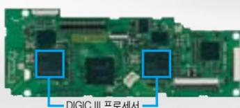
EOS-1Ds Mark III는 자연스러운 색상의 재현과 고속 처리를 가능케 한 영상 엔진 DIGIC III를 2개 채용하여 병렬 처리를 수행하고 있습니다. 이로써 이미지의 고속 처리, 기록 매체로의 고속 액세스 등이 실현되었으며, 특히 이전의 2배 (EOS-1Ds Mark II 대비)에 달하는 대용량의 버퍼 메모리를 탑재하고 있어 고화질이면서도 더욱 높아진 반응성을 자랑합니다.
