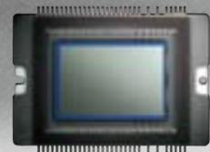
고화질 및 대형 출력의 요구에 부응한 EOS 40D의 1,010만 화소 CMOS 센서는 APS-C 사이즈 (22.2 x 14.8 mm)로 EF 렌즈의 약 1.6배에 해당하는 유효 화각을 제공하며 다이나믹 레인지가 더욱 확장되어 색도 영역과 하이라이트 영역에서의 디테일이 더욱 미세하게 표현됩니다.
