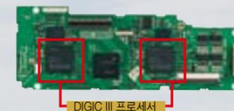
새로운 DIGIC III는, DIGIC II의 정교한 이미지 디테일과 자연스러운 색상 재현력을 그대로 유지하면서 1.5배 더 빠른 신호 처리 능력과 고감도에서의 더욱 뛰어난 노이즈 감소 처리 및 14bit 신호 처리 방식으로 더욱 고품질 이미지를 제공합니다. 10.1 메가픽셀 센서와 10fps의 최대 연속 촬영 속도로 인해 생성되는 대량의 신호를 원활히 처리하기 위해 EOS-1D Mark III는 두 개의 DIGIC III 이미지 프로세서를 탑재하여 병렬 신호 처리를 수행합니다.
