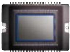
우수한 CMOS 센서 기술을 입증한 캐논은 EOS 400D를 위하여 APS-C 사이즈의 1,010만 픽셀 CMOS 센서를 새로이 개발하였습니다. 일반 EF 렌즈에 비해 1.6배 더 큰 화각을 제공하는 22.2 x 14.8mm의 이 고성능
