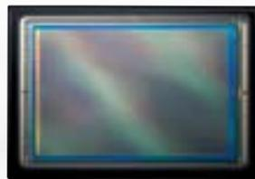
캐논이 개발한 2,110만 화소의 풀 사이즈 CMOS 센서 (36 x 24mm)는 대구경 EF 렌즈의 우수한 성능을 마음껏 이끌어 내는
