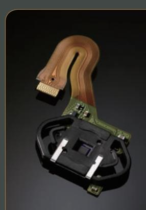
10만 화소의 RGB 측광 센서와 AE 전용의 이미지 프로세서가 결합된 새로운 AE 시스템 : EOS iSA (Intelligent Subject Analysis) System을 탑재함으로써 피사체의 밝기 외에도 얼굴과 색상까지 인식하여 이를 근거로 보다 정확한 피사체 검출 데이터를 산출해냅니다. 따라서 휙도 차이나 피사체의 색상 영향을 억제한 안정된 노출 제어를 실현할 수 있으며, 또한 AF 시스템과도 연계하여 피사체의 포착이나 움직이는 피사체의 추적이 정확해지는 등 AF의 기능도 크게 향상시킬 수 있게 되었습니다.
