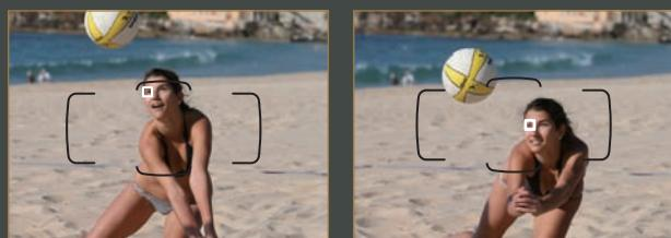
거리 정보와 더불어 EOS iSA System이 검출하는 얼굴이나 색상 정보를 활용하여 피사체의 움직임에 AF 프레임을 연동시키는 새로운 EOS iTR (Intelligent Tracking and Recognition) AF 기능을 탑재하여, 단일 포인트 AF 프레임으로 계속 추적하는 것이 어려운 고속의 피사체나 속도 또는 방향이 빠르게 바뀌며 움직이는 피사체에도 AF 프레임이 빠르고 정확하게 이동하여 초점을 연속적으로 맞춥니다.
