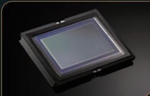
이미지 화소의 크기, 화소수, S/N 비와 같은 고화질을 위한 중요 요소들과 고속 판독 벨런스를 최적화하여 35mm 풀 프레임 사이즈의 CMOS 센서를 새로이 개발하였습니다. 유효 화면 사이즈 약 36.0 x 24.0mm, 유효 화소수 약 1,810만 화소의 넓은 화면과 높은 해상도로 표현되는 선명한
