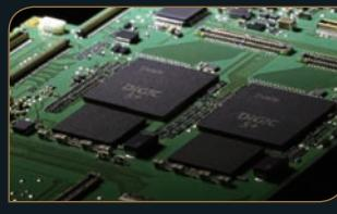
EOS - 1D X에 탑재된 이미지 프로세서는 새로이 개발된 DIGIC 5+로, 기존 DIGIC 4 프로세서에 비해 약 17 배의 처리 능력을 갖추어 빠르고 인텔리전트하게 이미지를 처리해냅니다. 이에 따라 노이즈를 효과적으로 제거하여 회칠 향상 및 ISO 감도 확장에 크게 기여하며, 뛰어난 성능을 배경으로 색수차 보정 및 다중 노출 촬영, 새로운 비디오 코덱의 채용 등과 같은 고급의 이미지 처리 기능을 제공합니다. EOS - 1D X는 이 고성능 프로세서를 2개 탑재하여 고속 별렬 처리함으로써 최고 약 14 프레임/초의 고속 연속 촬영\*을 실현하였습니다. \* 초고속 연속 촬영 모드 시
