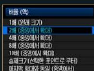
새롭게 채용된 확대/축소 전용 버튼을 누르고 메인 다이얼을 회전시켜 이미지를 확대/축소하여 재생할 수 있습니다. 오른손 엄지만으로 이미지의 확대 위치 이동 (멀티 컨트롤러)과 이미지 전환이 이루어 지므로, 대량의 이미지를 확인할 때에도 손가락의 움직임이 최소화됩니다. 확대/축소 버튼을 누를 때의 확대 배율과 표시 위치를 사전에 설정해 이미지 확인 작업을 한층 더 빨라지게 할 수도 있습니다.
