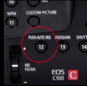
PUSH AUTO IRIS 촬영 시의 밝기에 따라 조리개를 자동으로 조정하는 촬영 어시스트 기능
